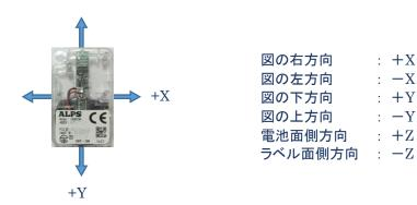
静止状態における IoT マルチセンサーの姿勢を一定条件に保つには、加速度センサーの数値から重力加速度のかかり方を見ると良いです。なお、"重力"の向きと"重力加速度"の向きは"逆転した関係性"になるので注意が必要です。例えば、IoT マルチセンサーを水平な台にラベル面側が上側に見えるように置いたとします。この場合は Z 軸方向にだけ重力加速度がかかるので、加速度センサーの計測値は理論的に、X 軸 O[G]、Y 軸 O[G]、Z 軸 O[G]0 ます。(ちなみに反転させて電池面側を上にすると、X 軸 O[G]0 、Y 軸 O[G]1 、Y 軸 O[G]2
