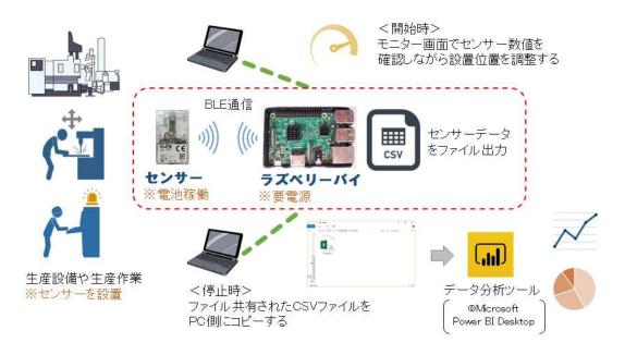
本ツールは、IoT マルチセンサーとラズベリーパイ(Raspberry Pi)で構成され、BLE(Bluetooth Low Energy)による無線通信を行います。センサーが計測するデータは、ラズベリーパイ上で稼働するアプリケーションによって CSV ファイルとして出力されるので、データ分析に用います。
