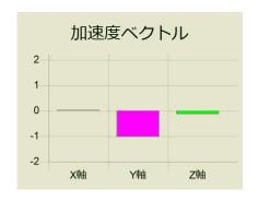
図の例から読み取れる IoT マルチセンサー姿勢は、"鉛直方向に電源スイッチが有る面が向けられている"と分かります。(台に置いた状態で、スイッチの突起が有る分、Z 軸方向に若干傾いていることも表れています)
